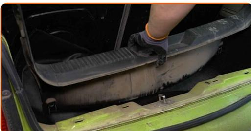
6 Schrauben Sie die Befestigungen der seitlichen Verkleidung des Kofferraums ab. Verwenden Sie den Torx T25.
