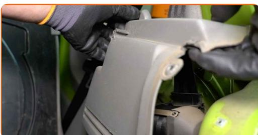
**9** Entfernen Sie die Schutzkappe der Stoßdämpferhalterung.
