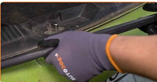
4 Schrauben Sie die Befestigungen der Ladekantenverkleidung ab.
