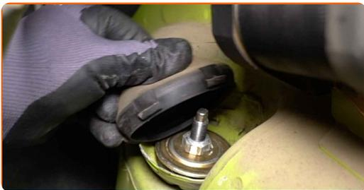
**10** Reinigen Sie die Stoßdämpferbefestigungen. Benutzen Sie eine Drahtbürste. Benutzen Sie WD-40-Spray.
