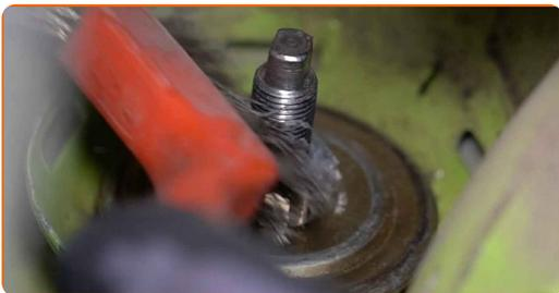
**11** Drehen Sie das obere Befestigungselement des Stoßdämpfers auf. Verwenden Sie Stecknuss Nr. 17. Verwenden Sie einen Stoßdämpfer Steckschlüsseinsatz DDN#6 Verwenden Sie einen Ratschenschlüssel.
