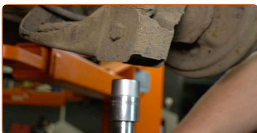
**18** Reinigen Sie die Stoßdämpferbefestigungen. Benutzen Sie eine Drahtbürste. Benutzen Sie WD-40-Spray.
