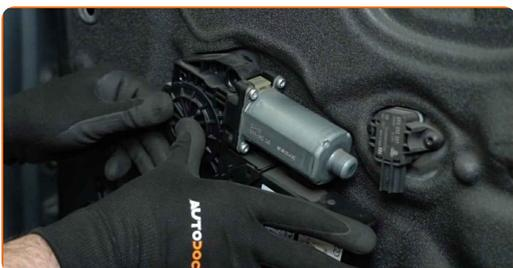
**62** Schrauben Sie die Befestigungen des Motors des elektrischen Fensterhebers ein. Verwenden Sie den Torx T27. Verwenden Sie einen Ratschenschlüssel.
