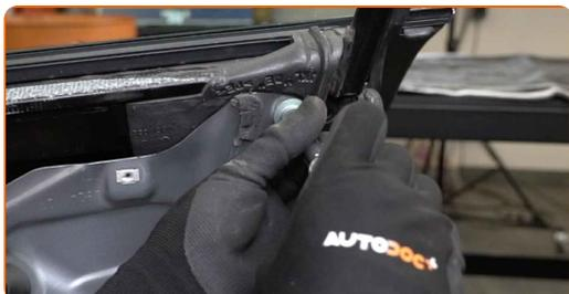
**48** Ziehen Sie die Schrauben des Außenspiegels fest. Verwenden Sie den Torx T30. Verwenden Sie einen Drehmomentschlüssel. Ziehen Sie ihn mit 15 Nm Drehmoment fest.
