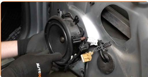
**57** Schraube die Befestigungselemente der Lautsprecher ein. Verwenden Sie den Torx T25. Verwenden Sie einen Ratschenschlüssel.
