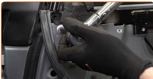
**52** Schrauben Sie die unteren Befestigungen des Fensterhebermechanismus ein. Verwenden Sie den Torx T25. Verwenden Sie einen Ratschenschlüssel.
