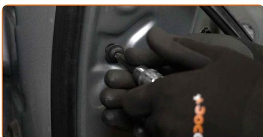
**51** Schrauben Sie die Befestigungen des Fensterrahmens fest. Verwenden Sie den Torx T45. Verwenden Sie einen Drehmomentschlüssel. Ziehen Sie ihn mit 35 Nm Drehmoment fest.
