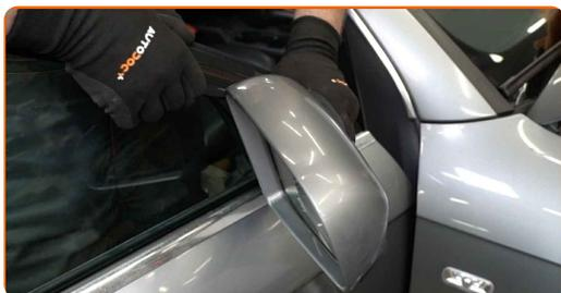
**46** Schrauben Sie die Befestigung des Außenspiegels ein. Verwenden Sie den Torx T30. Verwenden Sie einen Ratschenschlüssel.
