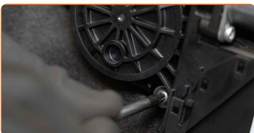
**63** Bringen Sie den Steckverbinder des elektrischen Fensterhebers am Türblech an.
