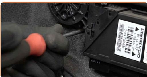
**17** Entfernen Sie den Motor des elektrischen Fensterhebers.
