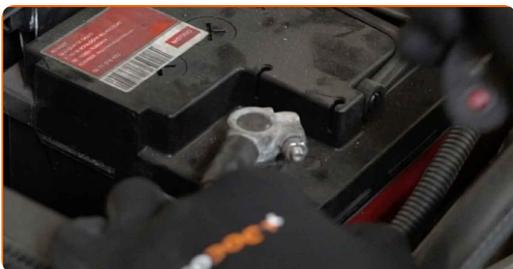
**4** Entfernen Sie die Batterieklammern.
