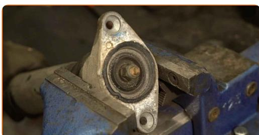
**17** Entfernen Sie die Schutzkappe der Stoßdämpferhalterung. Benutzen Sie ein Brecheisen.
