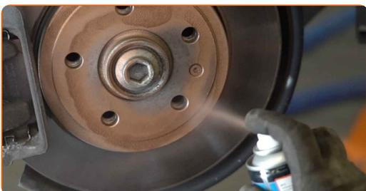
**40** Die Bremsscheibenoberfläche reinigen. Benutzen Sie einen Bremsenreiniger.
