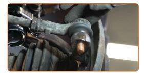
Schrauben Sie die Befestigungsmutter auf, die den Spurstangenkopf mit dem Achsschenkel verbindet. Verwenden Sie Stecknuss Nr. 19. Verwenden Sie einen Ratschenschlüssel.
