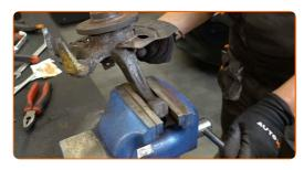
Behandeln Sie den Federbeinbefestigungssitz am Achsschenkel. Benutzen Sie eine Drahtbürste. Benutzen Sie WD-40-Spray.
