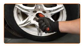
Drehen Sie das Befestigungselement der Antriebswelle auf. Verwenden Sie Stecknuss Nr. 30. Verwenden Sie ein Windeisen.
