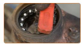
Entfernen Sie den Sicherungsring am Radnabenlager. Verwenden Sie eine Sicherungsringzange.
