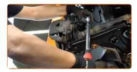
Installieren Sie die Staubschutzkappen der Bremssattel-Führungsstifte.
