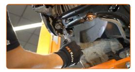
Behandeln Sie die Federbein-Befestigungen. Behandeln Sie die Befestigungen des Kugelgelenks. Behandeln Sie das Befestigungselement, das den Spurstangenkopf mit dem Achsschenkel verbindet. Benutzen Sie ein Kupferschmiermittel.
