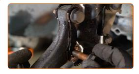
Schrauben Sie die Befestigungen ein, die das Federbein mit dem Achsschenkel verbinden. Verwenden Sie Ring-Gabelschlüssel Nr. 18. Verwenden Sie Stecknuss Nr. 18. Verwenden Sie ein Windeisen.
