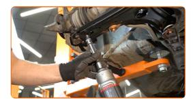
Reinigen Sie die Montagesitze des Spurstangenkopfes. Benutzen Sie eine Drahtbürste. Benutzen Sie WD-40-Spray.
