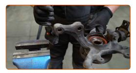
Entfernen Sie die Radnabe vom Achsschenkel. Verwenden Sie einen Druckstücksatz mit Ein-/Auspresswerkzeug.
