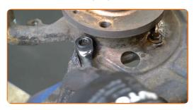
Entfernen Sie das Bremsenabdeckblech.
