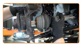
Befestigen Sie das Dämpferbein auf dem Achsschenkel.
