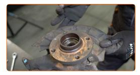
Reinigen Sie den Sicherungsring des Radnabenlagers. Benutzen Sie eine Drahtbürste. Benutzen Sie WD-40-Spray.
