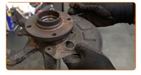
Drehen Sie die Befestigungen des Bremsenabdeckblechs ein. Verwenden Sie Ring-Gabelschlüssel Nr. 10.
