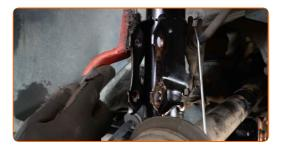
Behandeln Sie die Keilwellen des Antriebswellen-Gleichlaufgelenks. Benutzen Sie eine Drahtbürste. Benutzen Sie WD-40-Spray.
