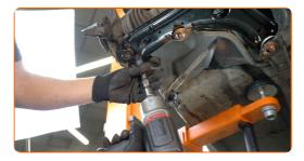
Entfernen Sie die Befestigungsmutter.
