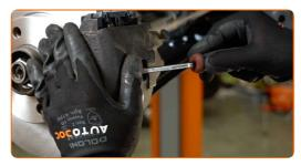
11 Entfernen Sie den Bremssattel.
