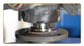
Stellen Sie den mit der Radnabe zusammengebauten Achsschenkel in einen Schraubstock.
