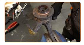
Reinigen Sie den Montagesitz des Bremsenabdeckblechs. Benutzen Sie eine Drahtbürste. Benutzen Sie WD-40-Spray.
