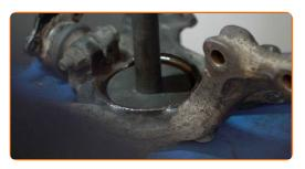
Ziehen Sie den Lagerinnenring aus der Radnabe heraus. Verwenden Sie einen Druckstücksatz mit Ein-/Auspresswerkzeug. Verwenden Sie ein ein Trennmesser für Lager.
