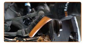
Lösen Sie das Ende der Befestigungsmutter an dem Achsschenkel. Verwenden Sie Stecknuss Nr. 19. Verwenden Sie einen Ratschenschlüssel.
