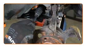
Schrauben Sie die Befestigungen ab, die das Federbein mit dem Achsschenkel verbinden. Verwenden Sie Ring-Gabelschlüssel Nr. 18. Verwenden Sie Stecknuss Nr. 18. Verwenden Sie einen Ratschenschlüssel.
