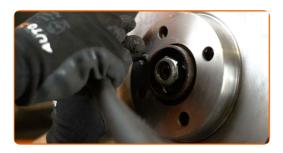
Entfernen Sie die Bremsscheibe.
