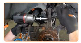
Entfernen Sie die Befestigungsschrauben.
