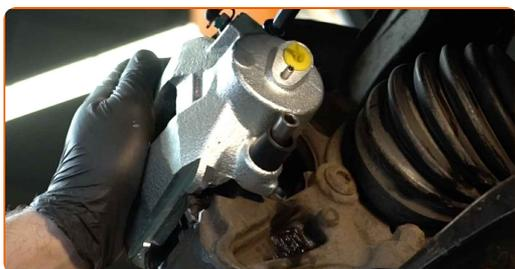
**20** Installieren Sie die Staubschutzkappen der Bremssattel-Führungsstifte.
