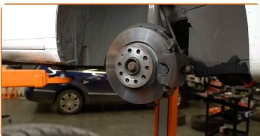
7 Reinigen Sie den Bereich, an dem der Bremsschlauch mit dem Bremssattel und der Bremskreisleitung verbunden ist. Benutzen Sie eine Drahtbürste. Benutzen Sie einen Bremsenreiniger.
