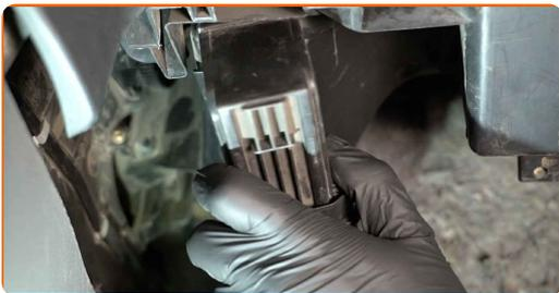
**4** Entfernen Sie den Gehäusedeckel des Innenraumfilters.
