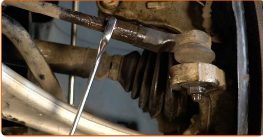
**9** Lösen Sie das Ende der Befestigungsmutter an dem Achsschenkel. Verwenden Sie Stecknuss Nr. 18. Verwenden Sie ein Windeisen.
