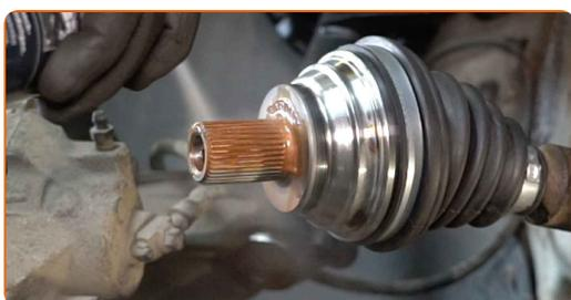
**36** Reinigen Sie den Kugelgelenk-Montagesitz. Benutzen Sie eine Drahtbürste. Benutzen Sie WD-40-Spray.
