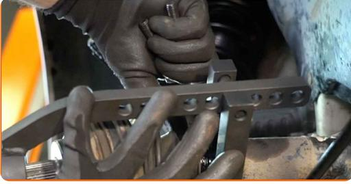
**24** Entfernen Sie das Gleichlaufgelenk zusammen mit seiner Manschette.
