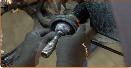
**29** Bringen Sie den Sicherungsring am Gleichlaufgelenk an.
