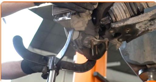
**16** Reinigen Sie die Klemmen der Gleichlaufgelenkmanschette. Benutzen Sie eine Drahtbürste. Benutzen Sie WD-40-Spray.
