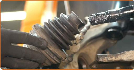
**25** Reinigen Sie den Montagesitz des Gleichlaufgelenks. Verwenden Sie Allzweckreinigungsspray.
