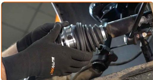
**34** Befestigen Sie die Klemmen der Gleichlaufgelenkmanschette. Verwenden Sie einen flachen Schraubendreher. Verwenden Sie eine Clic-R-Kragenzange. Benutzen Sie einen Hammer.
