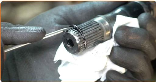
**27** Die Keilwellen des CV-Gelenks der Antriebswelle reinigen. Benutzen Sie eine Drahtbürste. Verwenden Sie Allzweckreinigungsspray.
