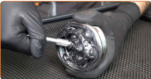
**32** Bauen Sie das neue Gleichlaufgelenk ein. Verwenden Sie einen Druckstücksatz mit Ein-/Auspresswerkzeug. Benutzen Sie einen Hammer.
