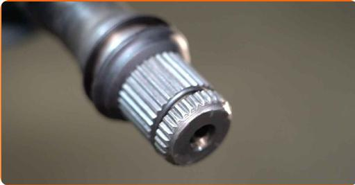
**30** Füllen Sie das Gleichlaufgelenk mit dem im Set enthaltenen Schmierfett.
