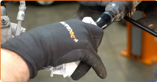
**26** Entfernen Sie den Sicherungsring vom Gleichlaufgelenk. Verwenden Sie einen flachen Schraubendreher.
