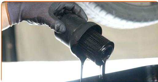
**13** Lösen Sie den Ölfilter vom Filterdeckel.
