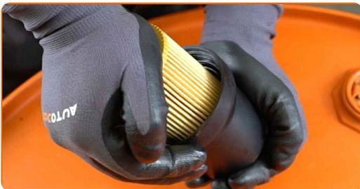
**18** Reinigen Sie die Ölfilteraufnahme. Verwenden Sie Allzweckreinigungsspray.
