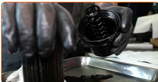
**14** Den Dichtungsring des Ölfilterdeckels entfernen.
