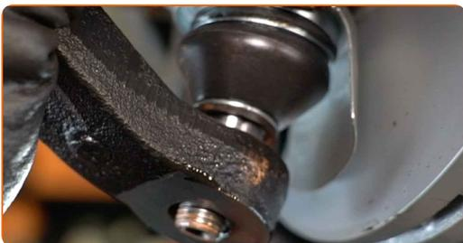
**19** Schrauben Sie die Befestigungen fest, die das Kugelgelenk mit dem Querlenker verbinden. Verwenden Sie Stecknuss Nr. 22. Verwenden Sie einen Drehmomentschlüssel. Ziehen Sie ihn mit 30 Nm Drehmoment fest.+90°
