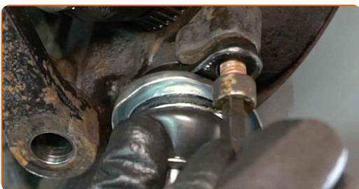
**18** Verbinden Sie das Kugelgelenk mit dem Lenker.
