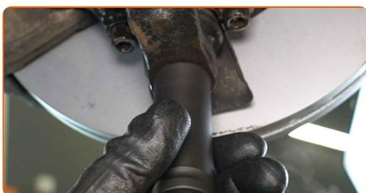
**8** Lösen Sie das Traggelenk vom Querlenker. Verwenden Sie einen Kugelgelenkabzieher.
