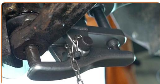
**9** Schrauben Sie die Befestigungen des Kugelgelenks vom Achsschenkel ab. Verwenden Sie Inbusschlüssel Nr. H8. Verwenden Sie einen Ratschenschlüssel.
