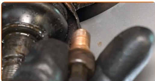
**11** Trennen Sie das Tragelenk vom Achsschenkel. Benutzen Sie ein Brecheisen.
