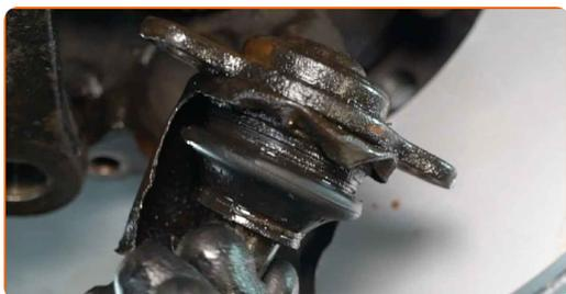
**13** Reinigen Sie den Kugelgelenk-Montagesitz. Benutzen Sie eine Drahtbürste. Benutzen Sie WD-40-Spray.
