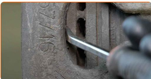
**8** Lösen Sie die Bremssattel-Haltefeder. Benutzen Sie ein Brecheisen.
