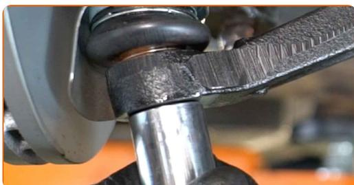
**21** Schrauben Sie die hintere Befestigung des Querlenkers ein. Verwenden Sie Stecknuss Nr. 21. Verwenden Sie einen Ratschenschlüssel.
