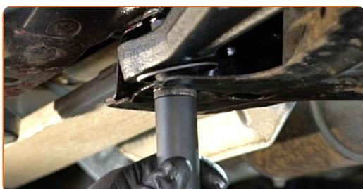
**22** Entfernen Sie die Stütze unter dem Hilfsrahmen.
