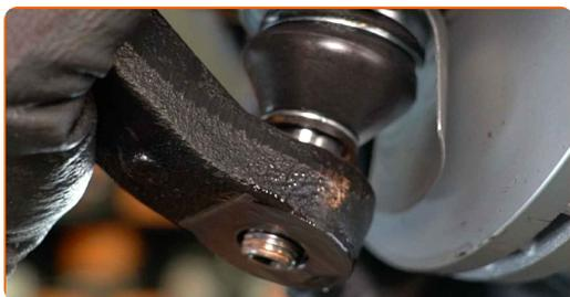
**20** Schrauben Sie das Befestigungselement ein, das den Achslenker mit dem Traggelenk verbindet. Verwenden Sie Stecknuss Nr. 21. Verwenden Sie einen Ratschenschlüssel.
