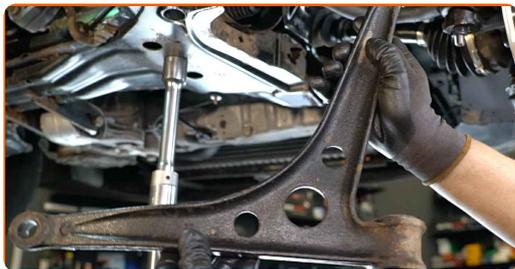
**16** Reinigen Sie die Montagesitze des Querlenkers. Benutzen Sie eine Drahtbürste. Benutzen Sie WD-40-Spray.
