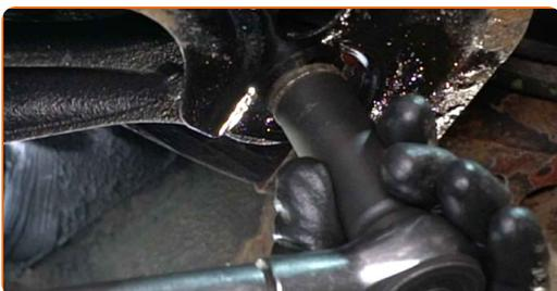
**26** Entfernen Sie den Träger unter dem Achsschenkel.
