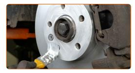
Die Bremsscheibenoberfläche reinigen. Benutzen Sie einen Bremsenreiniger.
