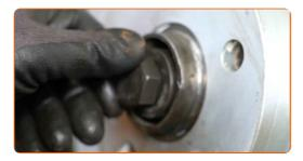
Schrauben Sie die Befestigungen der Antriebswelle an. Verwenden Sie Stecknuss Nr. 27. Verwenden Sie einen Ratschenschlüssel.
