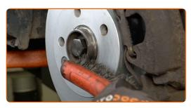
Behandeln Sie die Oberfläche, an der die Bremsscheibe die Felge berührt. Verwenden Sie Keramikfett.
