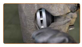
Die Befestigungselemente der Bremssattelhalterung reinigen. Benutzen Sie eine Drahtbürste. Benutzen Sie WD-40-Spray.
