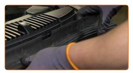
Schrauben Sie die Befestigung der Kunststoffplatte ab. Verwenden Sie Stecknuss Nr. 10. Verwenden Sie einen Ratschenschlüssel.
