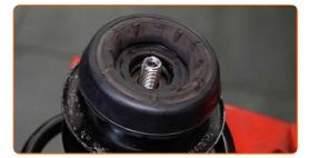
Ziehen Sie die Federbeinkolbenstangenmutter an. Verwenden Sie eine 21 mm Schienenmutterstecknuss. Verwenden Sie Inbusschlüssel Nr. H7. Verwenden Sie einen Drehmomentschlüssel. Ziehen Sie ihn mit 60 Nm Drehmoment fest.
