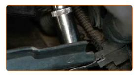
Bauen Sie die Dichtung der Windabweiserabdeckung ein.
