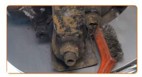
Schrauben Sie die Befestigungen des Kugelgelenks vom Achsschenkel ab. Verwenden Sie Inbusschlüssel Nr. H8. Verwenden Sie einen Ratschenschlüssel.
