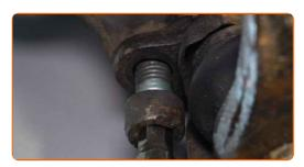
Ziehen Sie die Befestigungen fest, die das Kugelgelenk mit dem Achsschenkel verbinden. Verwenden Sie Inbusschlüssel Nr. H8. Verwenden Sie einen Drehmomentschlüssel. Ziehen Sie ihn mit 55 Nm Drehmoment fest.
