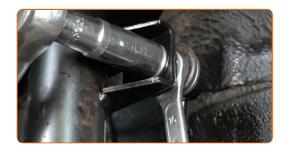
Schrauben Sie die unteren Befestigungen des Federbeins fest. Verwenden Sie Stecknuss Nr. 18. Verwenden Sie einen Drehmomentschlüssel. Ziehen Sie ihn mit 110 Nm Drehmoment fest.
