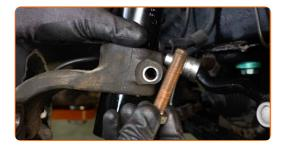
Schrauben Sie das untere Befestigungselement des Federbeins ein. Verwenden Sie Stecknuss Nr. 18. Verwenden Sie einen Ratschenschlüssel.
