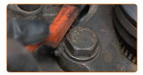
Lösen Sie die Befestigung der Sattelhalterung. Verwenden Sie Stecknuss Nr. 27. Verwenden Sie einen Ratschenschlüssel.
