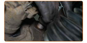
Ziehen Sie die Befestigungen des Bremssattelhalters fest. Verwenden Sie Stecknuss Nr. 27. Verwenden Sie einen Drehmomentschlüssel. Ziehen Sie ihn mit 200 Nm Drehmoment fest.
