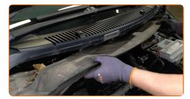
Reinigen Sie die obere Befestigung des Federbeinlagers. Benutzen Sie eine Drahtbürste. Benutzen Sie WD-40-Spray.
