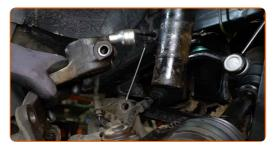
Lösen Sie die obere Befestigung der Federbeinbefestigung.
