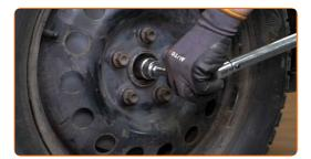
Ziehen Sie die Radschrauben unter Verwendung eines Kreuzmusters an. Verwenden Sie eine Schlagnuss für Felgen # 19. Verwenden Sie einen Drehmomentschlüssel. Ziehen Sie ihn mit 170 Nm Drehmoment fest.
