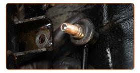
Trennen Sie die Verkabelung des ABS-Sensors.
