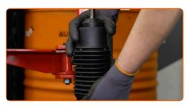
Installieren Sie die Feder am Stoßdämpfer.
