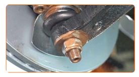
Behandeln Sie das Befestigungselement, das das Federbein mit dem Achsschenkel verbindet. Benutzen Sie ein Kupferschmiermittel.
