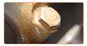
Behandeln Sie die Befestigung, die die Koppelstange mit dem Federbein verbindet. Benutzen Sie ein Kupferschmiermittel.
