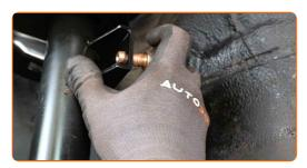
Ziehen Sie das Befestigungselement an, das die Druckstange mit dem Federbein verbindet. Verwenden Sie Ring-Gabelschlüssel Nr. 16. Verwenden Sie Stecknuss Nr. 19. Verwenden Sie einen Drehmomentschlüssel. Ziehen Sie ihn mit 100 Nm Drehmoment fest.
