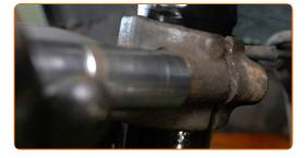
Entfernen Sie den Träger unter dem Achsschenkel.
