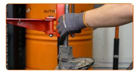
Setzen Sie einen neuen Stoßdämpfer in den hydraulischen Federspanner ein.
