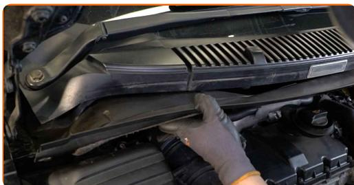
**14** Schrauben Sie die Befestigung der Kunststoffplatte an. Verwenden Sie Stecknuss Nr. 10. Verwenden Sie einen Ratschenschlüssel.
