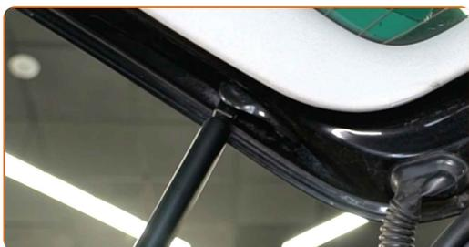
**15** Lassen Sie den Sprengring, der die Gasfeder mit der Karosserie verbindet, einrasten.
