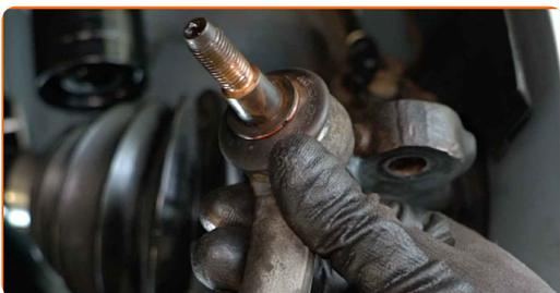
**12** Reinigen Sie die Montagesitze des Spurstangenkopfes. Benutzen Sie eine Drahtbürste. Verwenden Sie Allzweckreinigungsspray.
