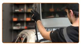
Bringen Sie die neue Gasfeder des Kofferraumdeckels an.
