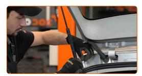
Lösen Sie den Sicherungsring, der die Gasfeder mit dem Kofferraumdeckel verbindet. Verwenden Sie einen flachen Schraubendreher.
