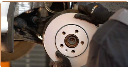
**18** Ziehen Sie die Befestigung der Bremsscheibe fest. Verwenden Sie einen Drehmomentschlüssel. Ziehen Sie ihn mit 4 Nm Drehmoment fest.
