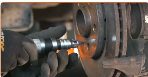
**15** Entfernen Sie die Bremsscheibe.
