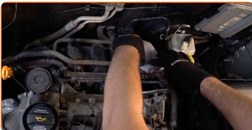
**5** Lösen Sie die Plastiksperrnasen des Zündspulensteckers. Verwenden Sie einen flachen Schraubendreher.
