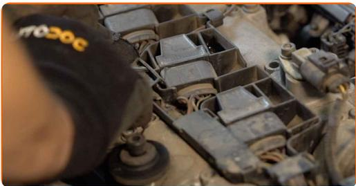
**6** Heben Sie die Zündspule an. Benutzen Sie ein Brecheisen (2 Teile).
