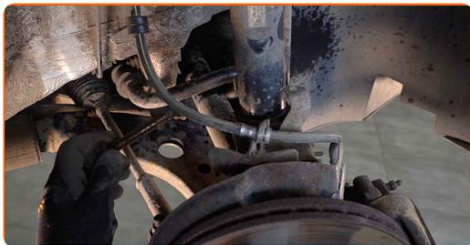
**16** Lösen Sie das untere Befestigungselement, dass das Federbein mit dem Achsschenkel verbindet. Verwenden Sie eine spezielle Schraubnuss, um den Stoßdämpfer zu entfernen. Verwenden Sie einen Ratschenschlüssel.
