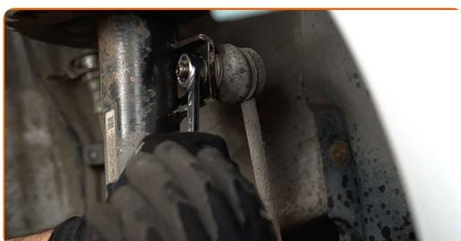
**13** Schrauben Sie das untere Befestigungselement ab, das das Federbein mit dem Achsschenkel verbindet. Verwenden Sie Ring-Gabelschlüssel Nr. 18. Verwenden Sie Stecknuss Nr. 18. Verwenden Sie ein Windeisen.
