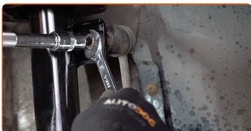
**51** Befestigen Sie den Bremsschlauch an der Strebe.
