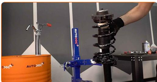
**37** Installieren Sie das Federbein am Radlauf.
