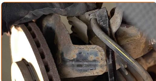
**15** Entfernen Sie die Befestigungsschraube.
