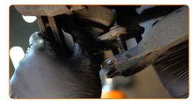
Lösen Sie das Befestigungselement, welches die Antriebswelle mit der Radnabe verbindet. Verwenden Sie Stecknuss Nr. 36.
