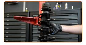
Installieren Sie das Federbein am Radlauf.
