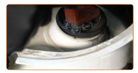
Lösen Sie die obere Befestigung des Domlagers. Verwenden Sie Ring-Gabelschlüssel Nr. 21. Verwenden Sie Inbusschlüssel Nr. H6. Verwenden Sie einen Ratschenschlüssel.
