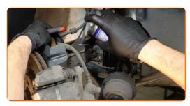
Befestigen Sie das Dämpferbein auf dem Achsschenkel.
