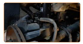
61 Montieren Sie den Querlenker.
