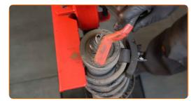
Entfernen Sie die Stangenmutter des Federkolben. Verwenden Sie Inbusschlüssel Nr. H6. Verwenden Sie Stecknuss Nr. 21. Verwenden Sie einen Ratschenschlüssel.
