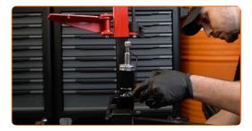
Installieren Sie die Staubschutzmanschette und den Anschlagpuffer auf dem neuen Stoßdämpfer.
