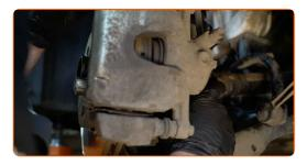
Verbinden Sie das Kugelgelenk mit dem Lenker.
