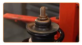
Entfernen Sie das zusammengebaute Federbein.
