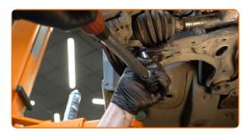
Ziehen Sie das Befestigungselement an, das die Druckstange mit dem Federbein verbindet. Verwenden Sie Stecknuss Nr. 16. Verwenden Sie einen Drehmomentschlüssel. Ziehen Sie ihn mit 40 Nm Drehmoment fest.
