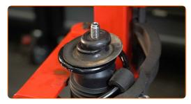
Ziehen Sie die Federbeinkolbenstangenmutter an. Verwenden Sie Inbusschlüssel Nr. H6. Verwenden Sie Stecknuss Nr. 21. Verwenden Sie einen Drehmomentschlüssel. Ziehen Sie ihn mit 60 Nm Drehmoment fest.
