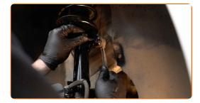
Ziehen Sie die Befestigungselemente des Stabilenkers fest. Verwenden Sie Stecknuss Nr. 16. Verwenden Sie einen Ratschenschlüssel.
