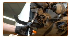
Entfernen Sie die Befestigungsschraube.
