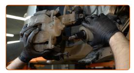
Stützen Sie die Achsschenkel auf. Benutzen Sie einen hydraulischen Getriebeheber.
