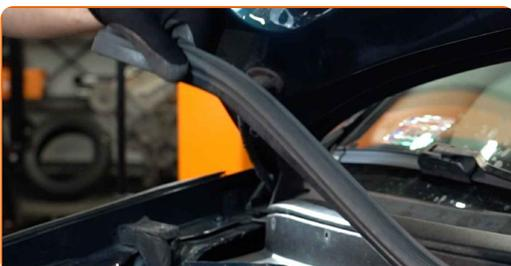
**5** Entfernen Sie den Gehäusedeckel des Innenraumfilters.
