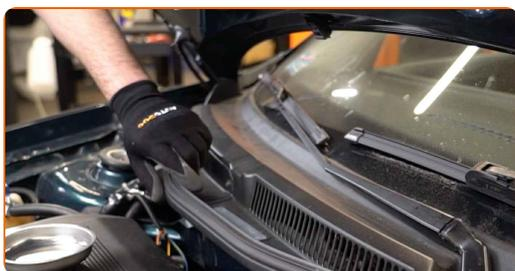
**13** Entfernen Sie die Kotflügel-Abdeckung.
