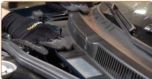
**11** Schrauben Sie die Verbindungselemente der Innenfilter-Gehäuseabdeckung ein. Verwenden Sie einen Kreuzschlitzschraubendreher.
