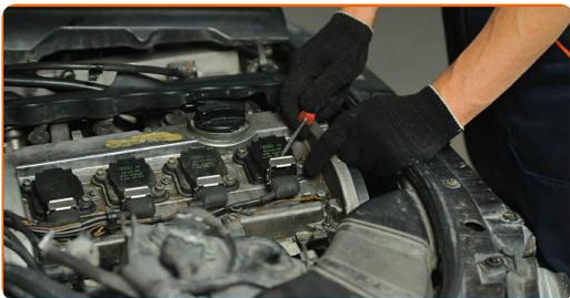
**6** Schrauben Sie die Befestigungsschrauben der Zündspulen ab. Verwenden Sie Inbusschlüssel Nr. H5. Verwenden Sie einen Ratschenschlüssel.
