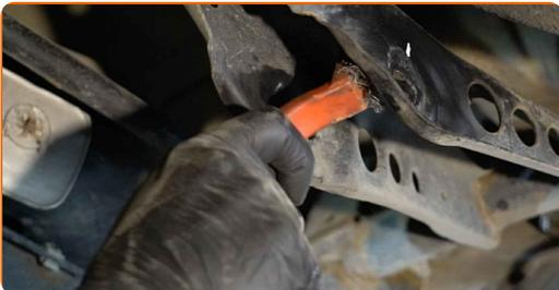
**45** Stützen Sie den Arm. Benutzen Sie einen hydraulischen Getriebeheber. Benutzen Sie ein Brecheisen.
