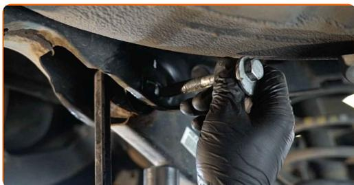
**16** Entfernen Sie den Träger unter dem Arm.
