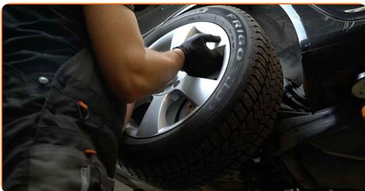
**61** Schrauben Sie die Radbolzen fest. Verwenden Sie eine Schlagnuss für Felgen # 17.
