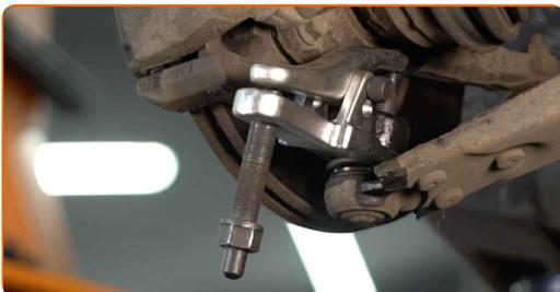
23 Reinigen Sie die untere Befestigung, die das Federbein mit dem Achsschenkel verbindet. Benutzen Sie eine Drahtbürste. Benutzen Sie WD-40-Spray.
