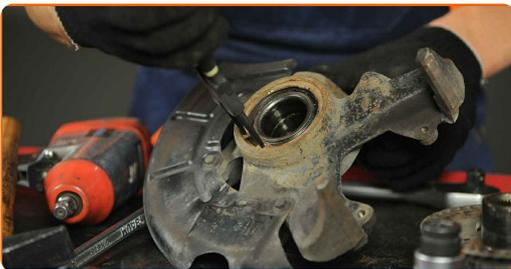
**30** Drücken Sie das Radnabenlager heraus. Verwenden Sie einen Druckstücksatz mit Ein-/Auspresswerkzeug.
