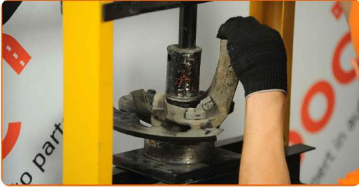
**31** Reinigen Sie den Einbauort für die Nabenlagerung. Benutzen Sie eine Drahtbürste. Benutzen Sie WD-40-Spray.
