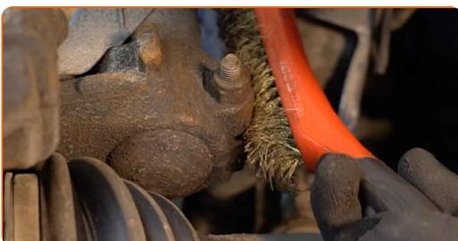
24 Schrauben Sie das untere Befestigungselement ab, das das Federbein mit dem Achsschenkel verbindet. Verwenden Sie Ring-Gabelschlüssel Nr. 18. Verwenden Sie Stecknuss Nr. 18. Verwenden Sie einen Ratschenschlüssel.
