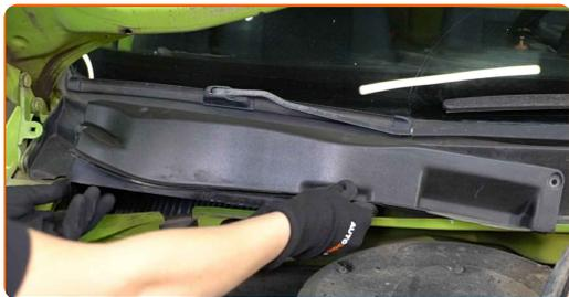
**14** Schrauben Sie die Befestigung der Kunststoffplatte an. Verwenden Sie einen Kreuzschlitzschraubendreher.
