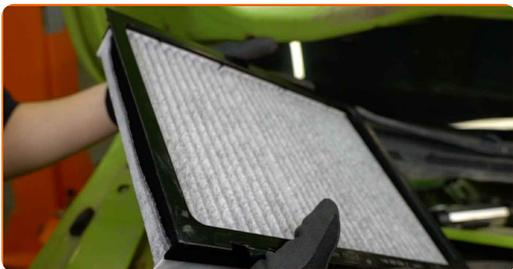
**11** Installieren Sie den Kabinenfilter an seinem Montagesitz.
