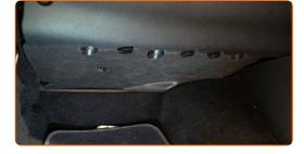
Befestige die Clips der unteren Armaturenbrettverkleidung.
