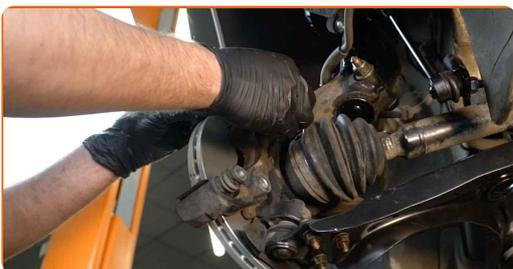
**23** Befestigen Sie die Bremssattelhalterung. Verwenden Sie Stecknuss Nr. 18. Verwenden Sie einen Drehmomentschlüssel. Ziehen Sie ihn mit 90 Nm Drehmoment fest.
