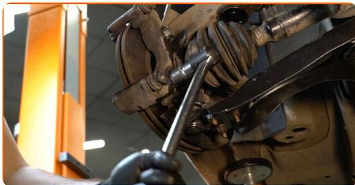
**14** Entfernen Sie die Sattelhalterung.
