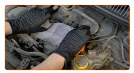
Entnehmen Sie die Zündspule aus der Vertiefung für die Zündkerze. Benutzen Sie ein Brecheisen.
