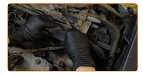
Bringen Sie die Zündspulen an den Zündkerzenbohrungen an. Stellen Sie sicher, dass Sie dabei das Klicken hören, welches entsteht, wenn sich diese in der korrekten Position befindet.
