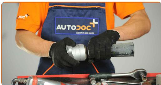
**17** Schrauben Sie die untere Befestigung der Federbeinkolbenstange an. Verwenden Sie Ring-Gabelschlüssel Nr. 17. Benutzen Sie einen Rollgabelschlüssel. Verwenden Sie einen Drehmomentschlüssel. Ziehen Sie ihn mit 25 Nm Drehmoment fest.
