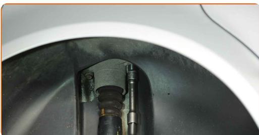
**12** Den Stoßdämpfer entfernen.
