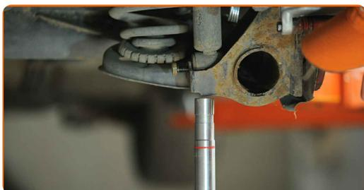
**9** Entfernen Sie die Befestigungsschraube.
