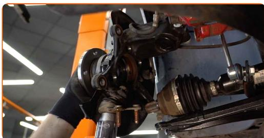
**27** Ziehen Sie die Nabe hindurch. Benutzen Sie den XZN #12. Verwenden Sie einen Drehmomentschlüssel. Ziehen Sie ihn mit 70 Nm Drehmoment fest.+90°
