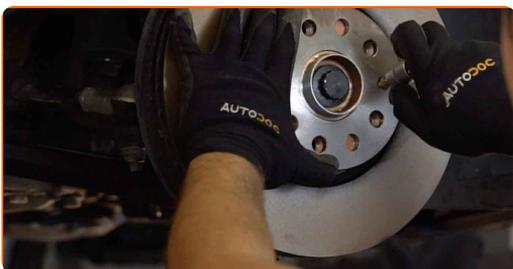
**35** Ziehen Sie die Befestigung der Bremsscheibe fest. Verwenden Sie den Torx T30. Verwenden Sie einen Drehmomentschlüssel. Ziehen Sie ihn mit 4 Nm Drehmoment fest.
