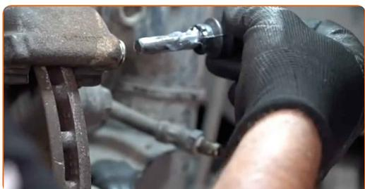
**28** Die Befestigungselemente der Bremssattelhalterung reinigen. Benutzen Sie eine Drahtbürste. Benutzen Sie WD-40-Spray.
