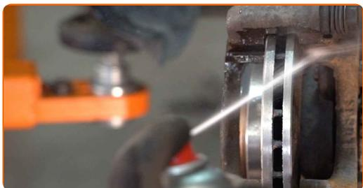
**29** Natrite upevňovacie prvky držiaka brzdového strmeňa. Verwenden Sie ein Dichtmittel.
