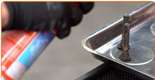
**25** Reinigen Sie die Bremssattel-Führungsstifte.
