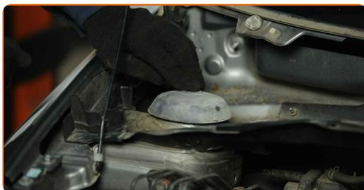
**47** Bringen Sie die Windlaufabdeckung an, die sich an der linken Seite befindet und sichern Sie sie.
