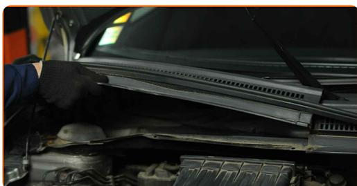
**22** Entfernen Sie die Schutzkappe der Stoßdämpferhalterung.
