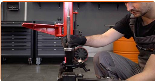
**37** Installieren Sie die Feder am Stoßdämpfer.
