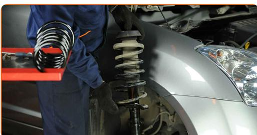
**27** Stellen Sie das Dämpferbein auf das Federspannwerkzeug.
