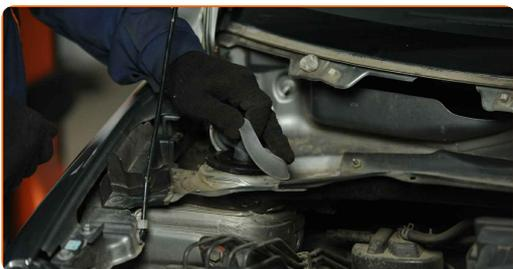
**24** Reinigen Sie die Befestigungselemente der oberen Federbeinhalterung. Benutzen Sie eine Drahtbürste. Benutzen Sie WD-40-Spray.
