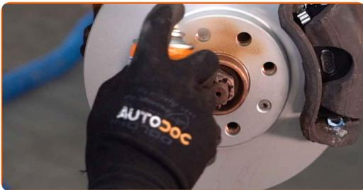
**60** Die Bremsscheibenoberfläche reinigen. Benutzen Sie einen Bremsenreiniger.
