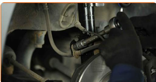
**12** Entfernen Sie die Halterung der Stoßdämpferstrebe.
