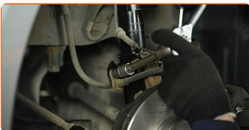
**55** Verbinden Sie das ABS mit der Sensorverdrahtung.
