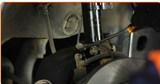
**10** Reinigen Sie das Befestigungselement der Halterung, die den Bremsschlauch mit dem Federbein verbindet. Benutzen Sie eine Drahtbürste. Benutzen Sie WD-40-Spray.
