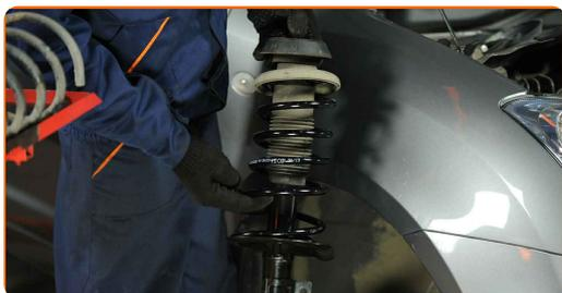
**41** Schrauben Sie die obere Befestigung des Domlagers an.
