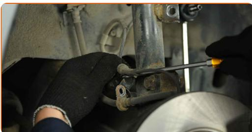
**13** Die Befestigungselemente, die das Federbein mit dem Achsschenkel verbinden, reinigen. Benutzen Sie eine Drahtbürste. Benutzen Sie WD-40-Spray.
