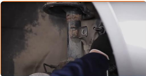
**9** Trennen Sie die ABS Sensorverdrahtung. Verwenden Sie einen flachen Schraubendreher.
