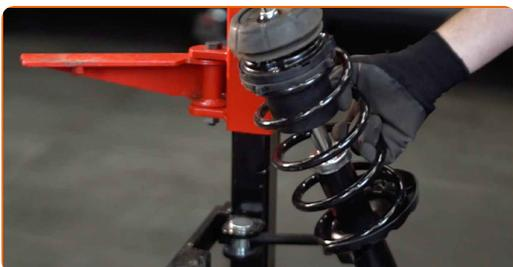
**40** Installieren Sie das Federbein am Radlauf.
