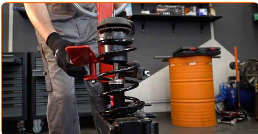
**37** Ziehen Sie die Federbeinkolbenstangenmutter an. Verwenden Sie Ring-Gabelschlüssel Nr. 19. Verwenden Sie Inbusschlüssel Nr. H6. Verwenden Sie einen Drehmomentschlüssel. Ziehen Sie ihn mit 50 Nm Drehmoment fest.
