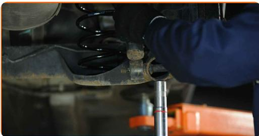
**18** Ziehen Sie den unteren Befestiger des Stoßdämpfers an. Verwenden Sie Stecknuss Nr. 17. Verwenden Sie einen Drehmomentschlüssel. Ziehen Sie ihn mit 90 Nm Drehmoment fest.
