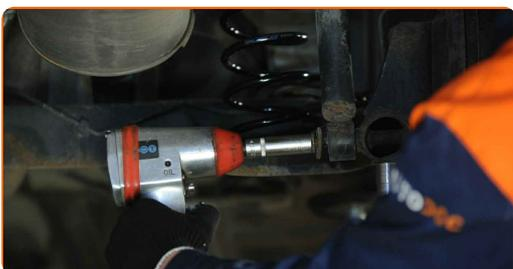
**19** Entfernen Sie den Träger unter der Achsschenkelachse.
