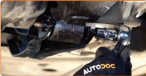
**Austausch: Motorlager – VW Transporter T4. AUTODOC-Experten empfehlen:**
