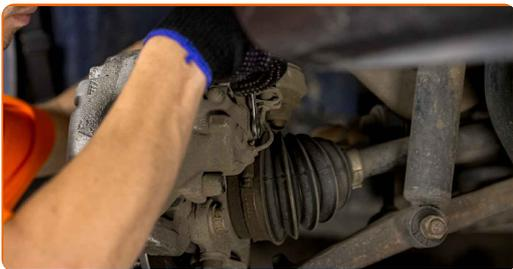
**10** Drehen Sie das Befestigungselement auf, das die Bremsleitung mit dem Bremssattel verbindet. Verwenden Sie einen offenen Ringschlüssel #11.
