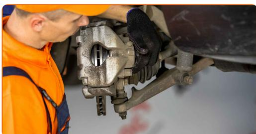
**9** Trennen Sie die Bremsschlauchhalter aus dem Bremssattel. Verwenden Sie Ring-Gabelschlüssel Nr. 10.
