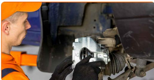
**18** Schrauben Sie die Führungsbolzen hinein. Verwenden Sie Inbusschlüssel Nr. H7. Verwenden Sie einen Drehmomentschlüssel. Ziehen Sie ihn mit 35 Nm Drehmoment fest.
