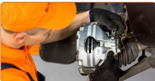
**25** Ziehen Sie die Entlüftungsschraube des Bremssattels an. Verwenden Sie Ring-Gabelschlüssel Nr. 11. Verwenden Sie einen Drehmomentschlüssel. Ziehen Sie ihn mit 10 Nm Drehmoment fest.
