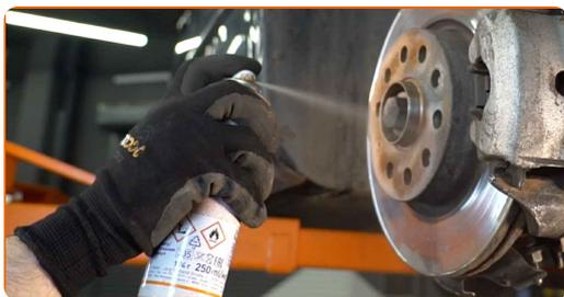
**18** Die Bremsscheibenoberfläche reinigen. Benutzen Sie einen Bremsenreiniger.
