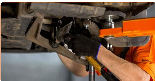
**14** Ziehen Sie das Befestigungselement an, das das Federbein mit dem Aufhängungs-Querlenker verbindet. Verwenden Sie Stecknuss Nr. 21. Verwenden Sie einen Drehmomentschlüssel. Ziehen Sie ihn mit 160 Nm Drehmoment fest.
