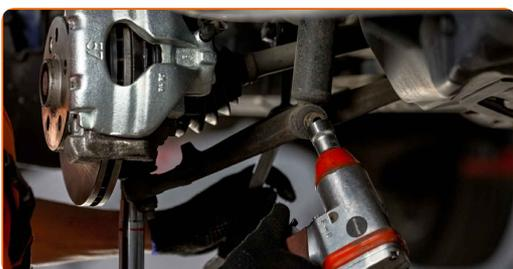
**15** Entfernen Sie den Träger unter dem Arm.
