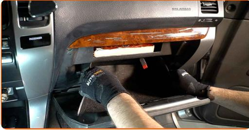
**4** Entfernen Sie das Luftfiltergehäuse.
