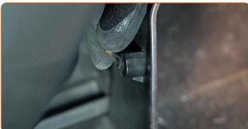
**3** Lösen Sie die Befestigungsclips der Innenraumfilterabdeckung.
