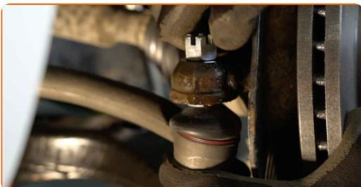
**18** Ziehen Sie die Befestigungsmutter an, die den Spurstangenkopf mit dem Achsschenkel verbindet. Verwenden Sie Stecknuss Nr. 19. Verwenden Sie einen Drehmomentschlüssel. Ziehen Sie ihn mit 49 Nm Drehmoment fest.
