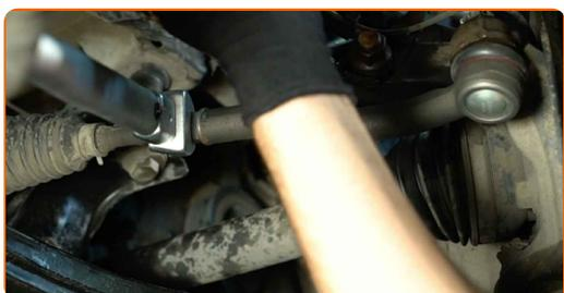
**21** Behandeln Sie das Befestigungselement, das den Spurstangenkopf mit dem Achsschenkel verbindet. Benutzen Sie ein Kupferschmiermittel.
