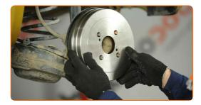
Behandeln Sie die Oberfläche, an der die Radfelge die Bremstrommel berührt. Benutzen Sie ein Kupferschmiermittel.
