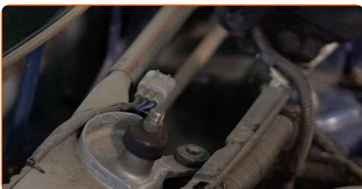
**8** Schrauben Sie die Befestigungen der Scheibenwischerverkleidung ab. Verwenden Sie Stecknuss Nr. 10. Verwenden Sie einen Ratschenschlüssel.
