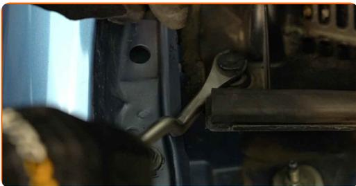
**6** Behandeln Sie die Befestigungen des Wischergestänges. Benutzen Sie WD-40-Spray.
