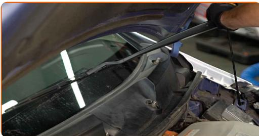
**5** Entfernen Sie die Wischerarm-Abdeckungen. Verwenden Sie einen Lösehebel, um die Clips zu entfernen.
