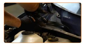
Verbinden Sie den Steckverbinder des Scheibenwischermotors.
