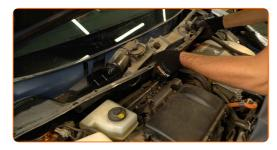
Schrauben Sie die Befestigungen der Scheibenwischerverkleidung ein. Verwenden Sie Stecknuss Nr. 10. Verwenden Sie einen Ratschenschlüssel.
