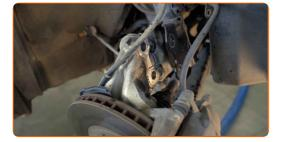
Lösen Sie die obere Befestigung des Domlagers.
