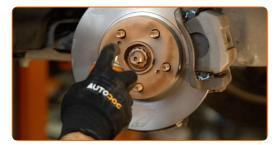
Die Bremsscheibenoberfläche reinigen. Benutzen Sie einen Bremsenreiniger.
