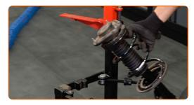
Installieren Sie das Federbein am Radlauf.
