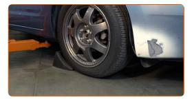
Lösen Sie die Radhalterungsschrauben. Verwenden Sie eine Schlagnuss für Felgen # 21.
