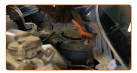
Lösen Sie die obere Befestigung des Domlagers. Verwenden Sie Stecknuss Nr. 12. Verwenden Sie einen Ratschenschlüssel.
