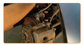
Entfernen Sie den Träger unter dem Achsschenkel.
