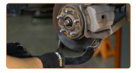
Entfernen Sie die Befestigungsschrauben.
