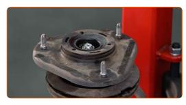
Entfernen Sie die Stangenmutter des Federkolben. Verwenden Sie Stecknuss Nr. 19. Verwenden Sie einen Ratschenschlüssel.
