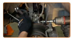
Befestigen Sie den Bremsschlauch an der Strebe. Schließen Sie das Befestigungslement des ABS-Sensorkabels an die Stoßdämpferstrebe an. Verwenden Sie Stecknuss Nr. 12. Verwenden Sie einen Ratschenschlüssel.
