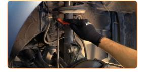
Lösen Sie die Verdrahtung und den Bremsschlauch aus der Halterung am Federbein. Verwenden Sie Stecknuss Nr. 12. Verwenden Sie einen Ratschenschlüssel.
