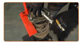
Entfernen Sie die Stoßdämpferhalterung, die Manschette und den Stoßstopp. Benutzen Sie ein Brecheisen.
