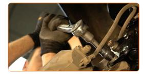
Montieren Sie den Querlenker.
