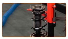
Entfernen Sie das zusammengebaute Federbein.
