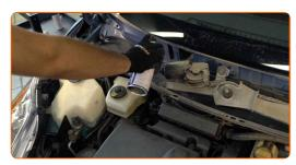
Lösen Sie den Steckverbinder des Scheibenwischermotors.
