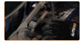
Schrauben Sie die Befestigungen der Scheibenwischerverkleidung ab. Verwenden Sie Stecknuss Nr. 10. Verwenden Sie einen Ratschenschlüssel.
