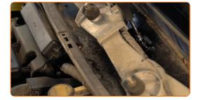
9 Entfernen Sie die Verkleidung, die mit dem Wischergestänge verbunden ist.
