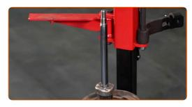
Installieren Sie die Feder am Stoßdämpfer.
