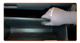
Lösen Sie die Befestigungsclips der Innenraumfilterabdeckung.
