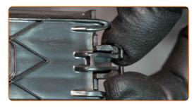
Entfernen Sie den Gehäusedeckel des Innenraumfilters.
