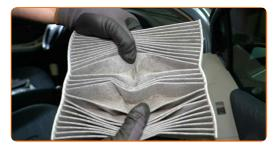
Austausch: Innenraumfilter – TOYOTA COROLLA Stufenheck (\_E12J\_, \_E12T\_).
