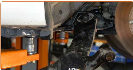
**24** Reinigen Sie die Montagebohrungen und die Gewinde des Querlenkers. Benutzen Sie eine Drahtbürste. Benutzen Sie WD-40-Spray.
