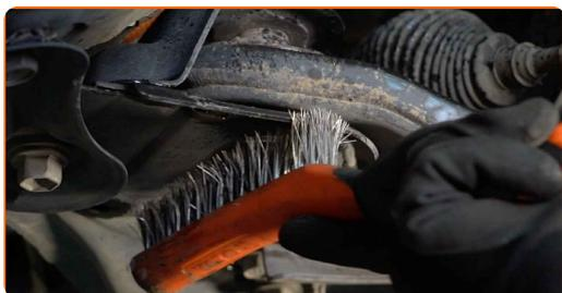
**20** Reinigen Sie die Befestigungselemente, die den Querlenker mit dem Hilfsrahmen verbinden. Benutzen Sie eine Drahtbürste. Benutzen Sie WD-40-Spray.
