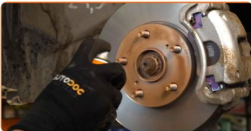
**42** Die Bremsscheibenoberfläche reinigen. Benutzen Sie einen Bremsenreiniger.
