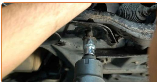
**22** Lösen Sie die hintere Befestigung des Querlenkers.
