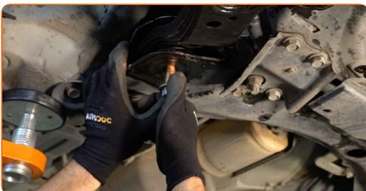
**30** Schrauben Sie das hintere Befestigungselement ein, das den Querlenker mit dem Hilfsrahmen verbindet. Verwenden Sie Ring-Gabelschlüssel Nr. 22. Verwenden Sie Stecknuss Nr. 22. Verwenden Sie einen Ratschenschlüssel.
