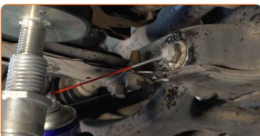
**18** Schrauben Sie die vordere Armbefestigung ab. Verwenden Sie Stecknuss Nr. 22. Verwenden Sie ein Windeisen.
