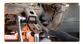
Ziehen Sie das Befestigungselement an, das den Querlenker mit der Karosserie verbindet. Verwenden Sie Ring-Gabelschlüssel Nr. 19. Verwenden Sie Stecknuss Nr. 19. Verwenden Sie einen Drehmomentschlüssel. Ziehen Sie ihn mit 130 Nm Drehmoment fest.
