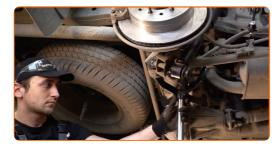
Reinigen Sie die Feststellbremshalterung. Benutzen Sie eine Drahtbürste. Benutzen Sie WD-40-Spray.
