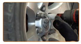
Senken Sie das Auto und ziehen Sie die Radschrauben über Kreuz an. Verwenden Sie einen Drehmomentschlüssel. Ziehen Sie ihn mit 112 Nm Drehmoment fest.
