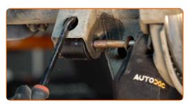
Ziehen Sie das Befestigungselement an, das den Längslenker mit der Karosserie verbindet. Schrauben Sie das Befestigungselement ein, das den Querlenker mit dem hinteren Hilfsrahmen verbindet. Verwenden Sie Ring-Gabelschlüssel Nr. 19.
