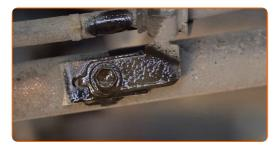
Lösen Sie die Schraube und entfernen Sie die Feststellbremsen-Kabelhalterung vom Längslenker. Verwenden Sie Stecknuss Nr. 12.
