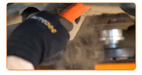
Schrauben Sie die Armbefestigung vom Balken ab. Verwenden Sie Stecknuss Nr. 19. Verwenden Sie ein Windeisen.
