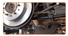
Ziehen Sie die Armbefestigung am Balken an. Verwenden Sie Ring-Gabelschlüssel Nr. 19. Verwenden Sie Stecknuss Nr. 19. Verwenden Sie einen Drehmomentschlüssel. Ziehen Sie ihn mit 130 Nm Drehmoment fest.
