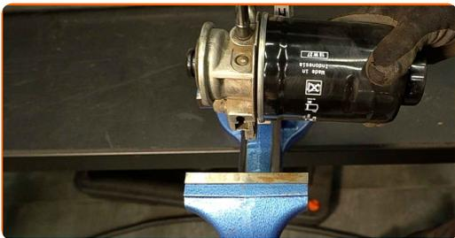
**19** Bringen Sie das Schutzgehäuse des Kraftstofffilters an.
