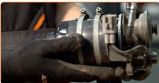
**20** Ziehen Sie die Schellen des Schutzgehäuses des Kraftstofffilters an. Verwenden Sie Stecknuss Nr. 8.
