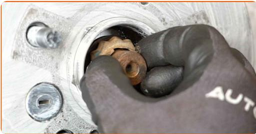
**58** Setzen Sie den Splint ein. Benutzen Sie ein Brecheisen.
