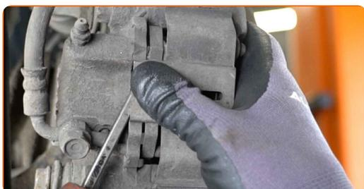
**16** Verteilen Sie die Bremsbeläge. Benutzen Sie ein Brecheisen.
