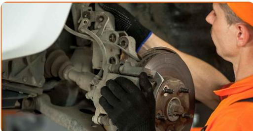
**42** Befestigen Sie das Dämpferbein auf dem Achsschenkel. Benutzen Sie ein Brecheisen.
