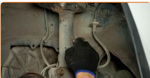
**44** Schrauben Sie das Befestigungselement ein, das das Federbein mit dem Achsschenkel verbindet.
