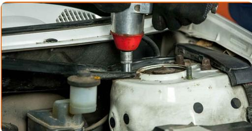
**19** Lösen Sie die obere Befestigung des Domlagers.
