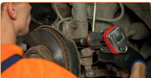
**45** Befestigen Sie den Bremsschlauch an der Strobe. Schließen Sie das Befestigungselement des ABS-Sensorkabels an die Stoßdämpferstrobe an. Verwenden Sie Stecknuss Nr. 12. Verwenden Sie einen Ratschenschlüssel.
