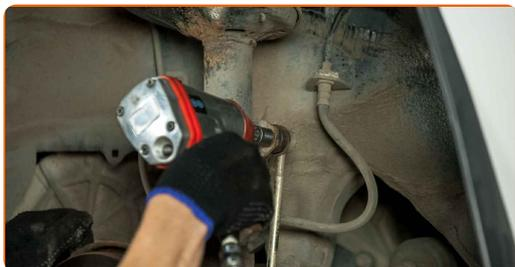
**48** Ziehen Sie die unteren Befestigungen an, die das Federbein mit dem Achsschenkel verbinden. Verwenden Sie Ring-Gabelschlüssel Nr. 19. Verwenden Sie Stecknuss Nr. 19. Verwenden Sie einen Drehmomentschlüssel. Ziehen Sie ihn mit 143 Nm Drehmoment fest.
