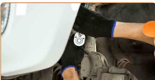
**46** Montieren Sie den Querlenker.
