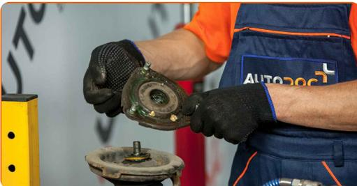
**27** Behandeln Sie die Befestigungselemente des Federbeinstützlagers. Benutzen Sie WD-40-Spray.
