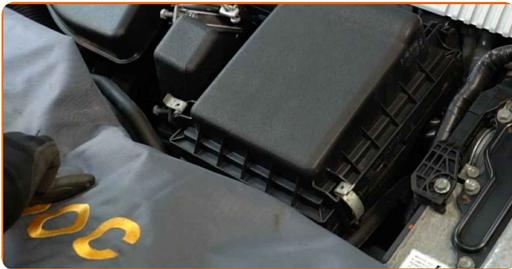
**13** Ziehen Sie die Klemme am Luftansaugschlauch fest. Verwenden Sie Stecknuss Nr. 10. Verwenden Sie einen Ratschenschlüssel.
