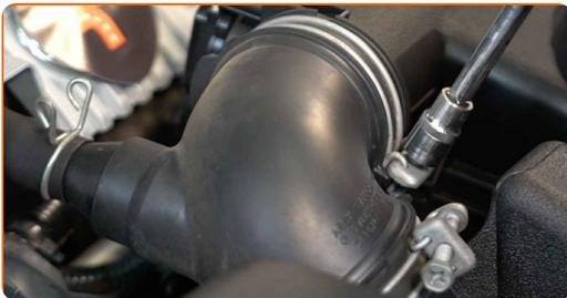
**4** Lösen Sie die Befestigungsclips der Luftfilterabdeckung.
